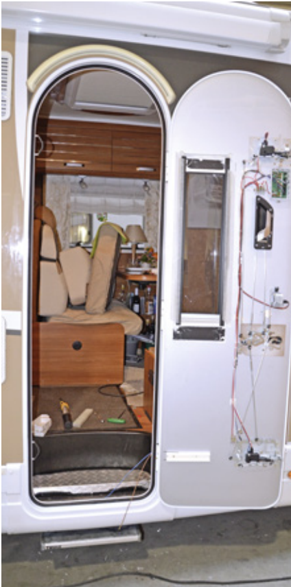
Bis auf die Innenverkleidung ist die Tür fertig montiert
