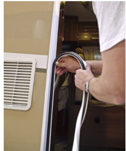
Die Dichtung wird aufgezogen
